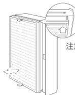
注意：滤芯侧面凸台对准滤芯仓正面凹槽进行安装
