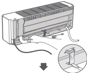
将粗、细连接配管喇叭口对准室内机粗、细配管相应的螺纹接头中心，充分旋紧。
