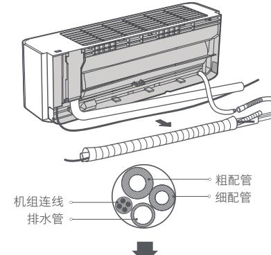
根据出管方向，拆下左侧或右侧出管缺口处的卡板；如从后方
