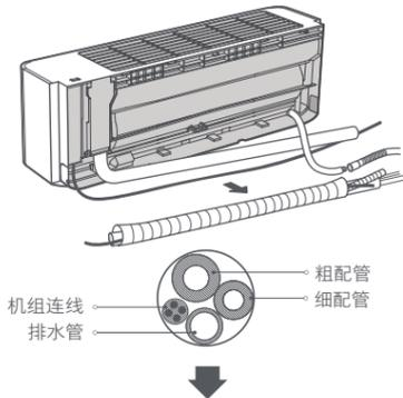
根据出管方向，拆下左侧或右侧出管缺口处的卡板；如从后方出管，则无需拆卸左右卡板。
