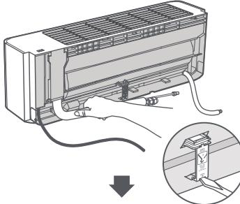
将粗、细连接配管喇叭口对准室内机粗、细配管相应的螺纹接头中心，充分旋紧。
