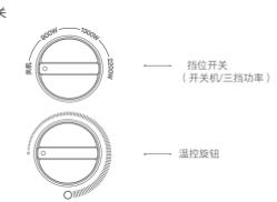
档位开关：开/关机，调节功率，功率越高，加热越快。
