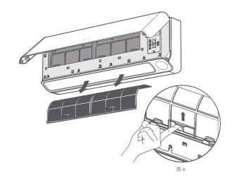
1 取出过滤网 打开面板,稍向上提过滤网中央下部的提手(如图 a), 然后下拉, 取出过滤网。
