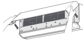
将面板铰钩装入机身内槽,稍用力往里推,同时向上 抬起, 听到"咔嗒"声, 向下按前面板, 即可合上面板。
