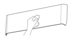
3 清洗面板 使用清水或稀释的中性洗涤剂,用软布或海绵清洗。
